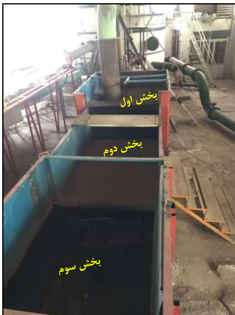
شکل ۹- نمایی از مخزن فلزی پایین دست، جهت کاهش آشفتگی و تلاطم جریان خروجی
