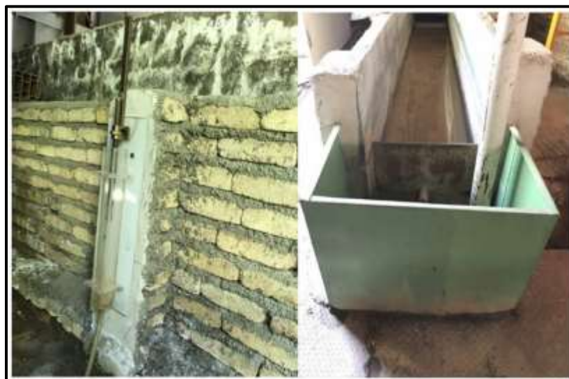
شکل ۱۷- سرریز لبه تیز مستطیلی و لیمینومتر مورد استفاده جهت اندازه‌گیری تغییرات بار آبی بالادست سرریز
