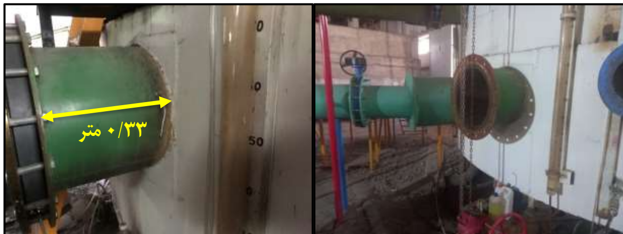
شکل ۵- نمایشی از ورودی مدل آزمایشگاهی (قطر ۱۶ اینچ و طول ۳۳ سانتی متر)
